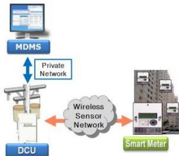
Figure 10 : Représentation schématique d'un AMI [29]
