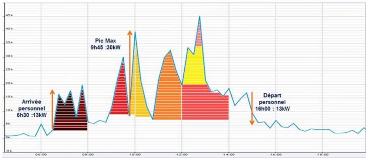
Figure 13 : Pics de puissance correspondant à l'activité du restaurant du technopôle de Sierre, 03/12/2013 [8]
