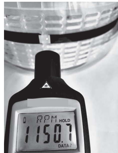
Figure 2. Tachymètre laser avec affichage de la vitesse de rotation en tours par minute
