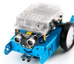
Le Mbot possède aussi un protocole de communication ORION qui permet de communiquer entre une interface et la carte du robot mbot.
