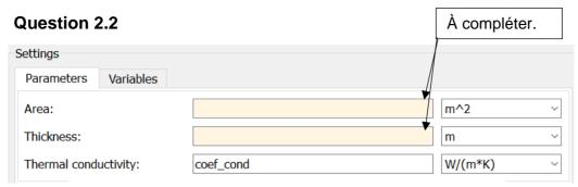
Bloc 'Conduction 1' de la fenêtre
